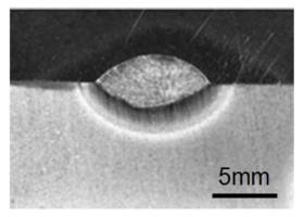
Fig. 3 An example of welded DHW.
