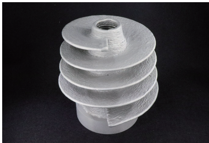
造形方法:WAAM 使用電源:Fronius製TPS5000-CMT
