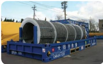
列車・トレーラー共に積載可能な鋼材専用無蓋コンテナ
