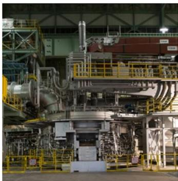
炉体旋回式電気炉(STARQ®)
