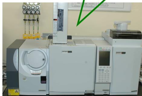
GC/MS(ガスクロマトグラフ・質量分析装置)
