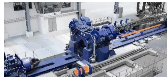
大型四面鍛造機（27年度完工予定）
