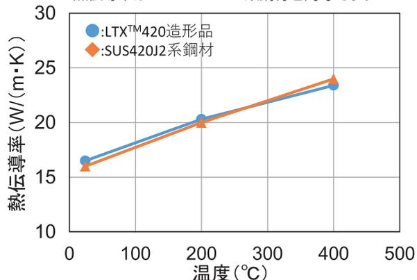
図6. 低温焼戻し材の熱伝導率比較
