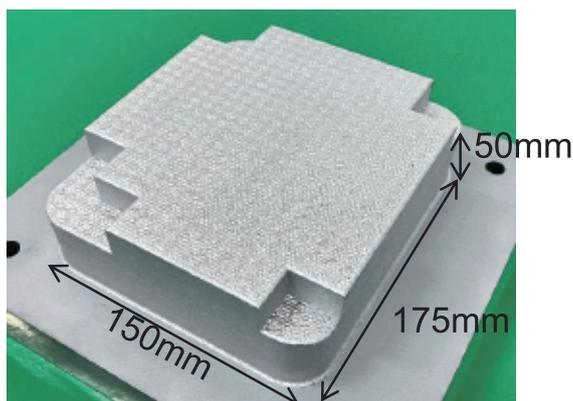
図7. 模擬型造形例 (ベースプレート温度120℃)
