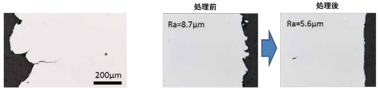
図 12. 造形後の焼戻しで発生した初期のき裂
