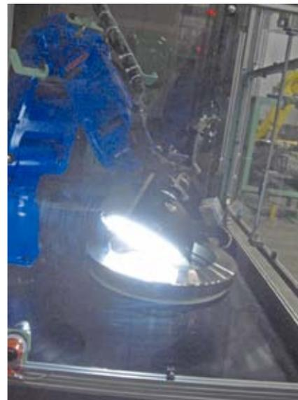
図6 自動外観検査装置
