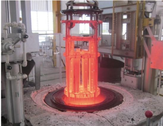
図2 TD処理中（塩浴から引き上げた直後）の写真
