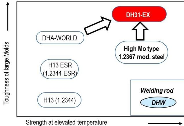
Fig. 2. Positioning of DH31-EX
