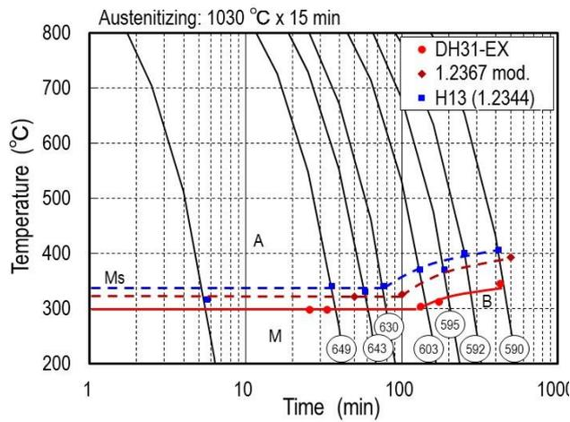
Fig. 3. CCT diagrams of DH31-EX
