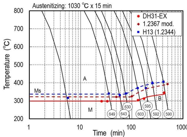
Fig. 3. CCT diagrams of DH31-EX
