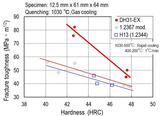
Fig. 13 Fracture toughness
