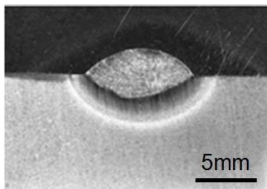
Fig. 3 An example of welded DHW.
