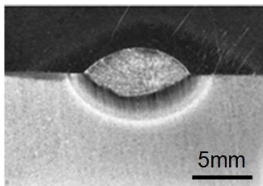
Fig. 3 An example of welded DHW.
